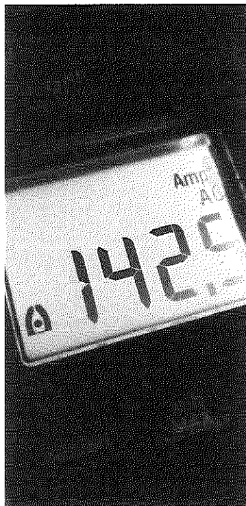
Medición de la corriente de la fase B del tablero general.
